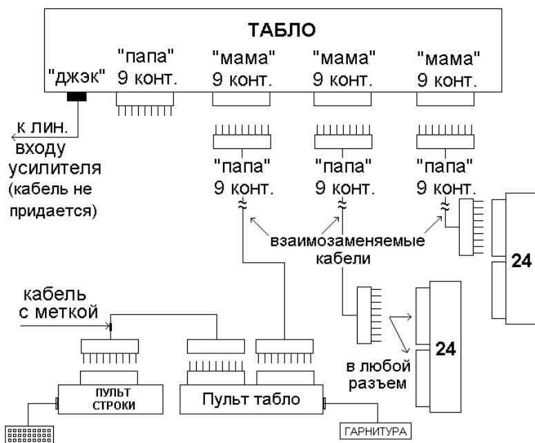
В типовом варианте пульт и два репитера подключаются непосредственно к табло. Это используется в случае, когда табло
