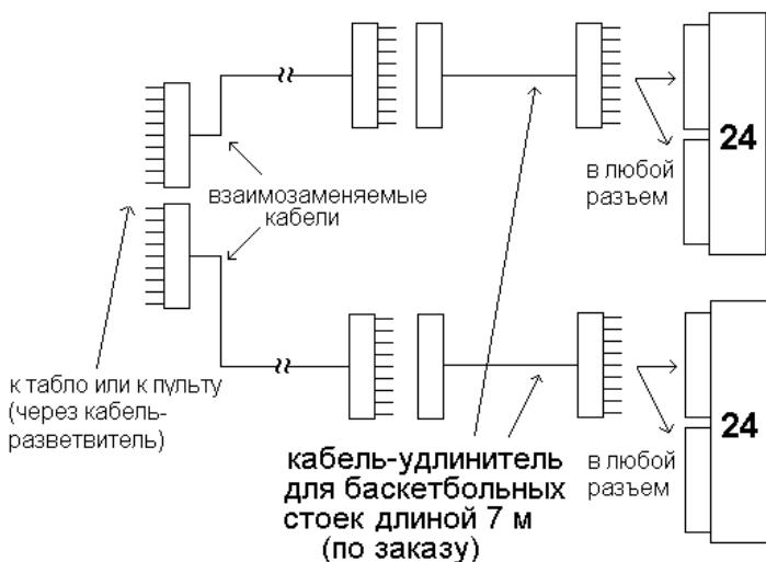
Это нужно, чтобы стойки можно было отключать при перемещении. Разумеется, эти кабели-удлинители применимы в любой конфигурации включения табло.
